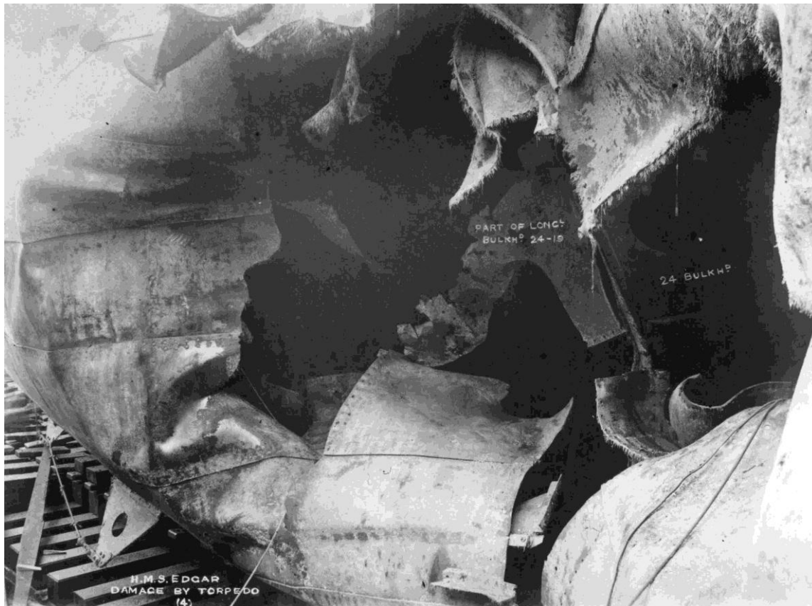
Abb.: Schaden durch Torpedo von U 29 auf dem britischen Kreuzer EDGAR. Aufnahme im Dock auf der Insel Malta (IWM SP 3108)
