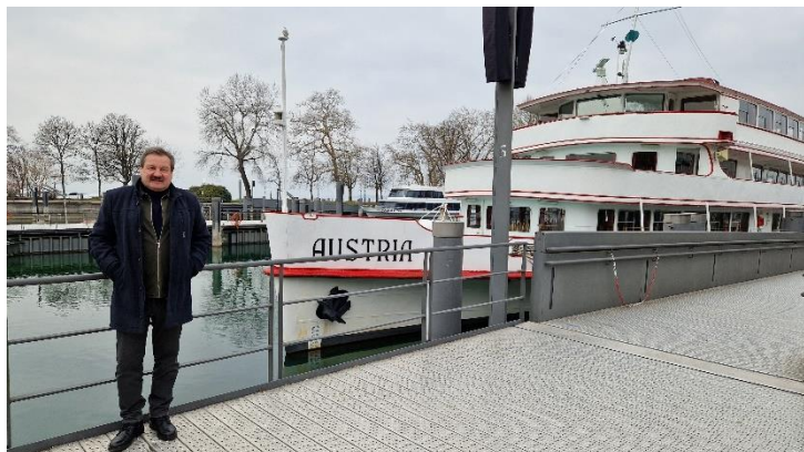
Foto oben zeigt M/S AUSTRIA in Bregenz 1950 und rechts mit OE6NFK im Hafen von Bregenz im Februar 2025. M/S AUSTRIA, Bj. 1939, Schiffswerft Korneuburg/Donau, 60m lg., 458t, 1.492PS, 32km/h, 1.200 Personen.
